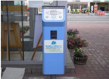
電気自動車の将来の普及に向けた実証実験 の為に青森県で設置した充電スタンド
